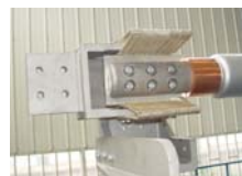
触头复合旋转示意图
